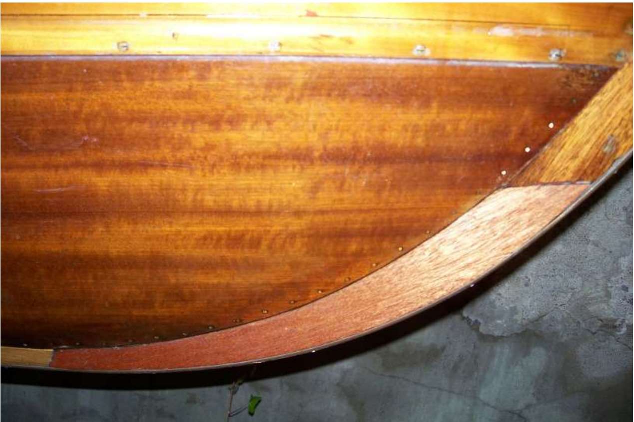
Einsetzen eines Stücks Kielleiste am Kitzinger Kätherle
